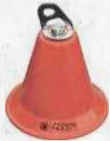
Ofrece una solución para sistemas de línea de vida anti caídas sobre la mayoría de techos. Una de las principales características es la forma cónica, ya que utiliza el material de manera eficaz para deformarse. Cuenta con un absorbedor interno de energía, diseñado para limitar la fuerza en la estructura y en el usuario en caso de una caída. El dispositivo se atornilla a la placa base cuadrada, cruz, redonda y rígida Scope Multi.
