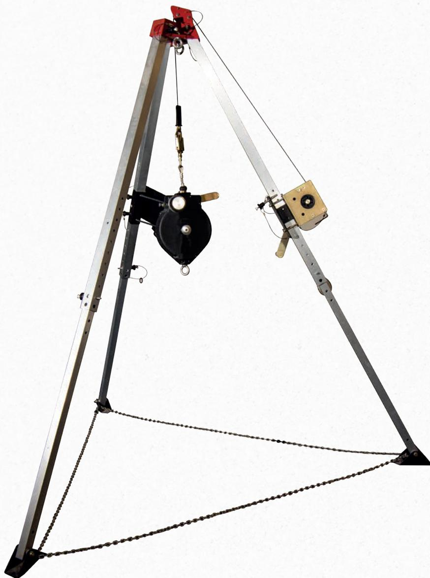
Diseñado para acceso, evacuación y rescate en espacios confinados. Utiliza un cabrestante como sistema primario de acceso y evacuación, aparte de un retráctil con manivela como sistema secundario para detención de caídas, recuperación y/o rescate. Su fácil manejo e instalación, lo convierte en un sistema portátil. Incluye bolsa para su traslado y protección.
